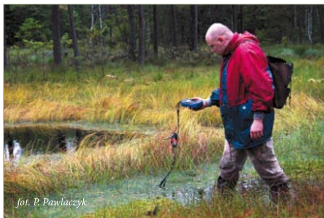
Pomiary pH i przewodnictwa elektrycznego na torfowisku pH and electrical conductivity recording
