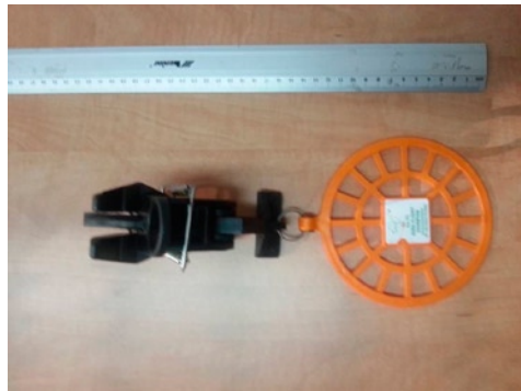
Fot. 4. Zawieszka nieobrotowa (Fot. M. Pakuła). Photo 4. Non-rotating sign element (Photo by: M. Pakuła).
