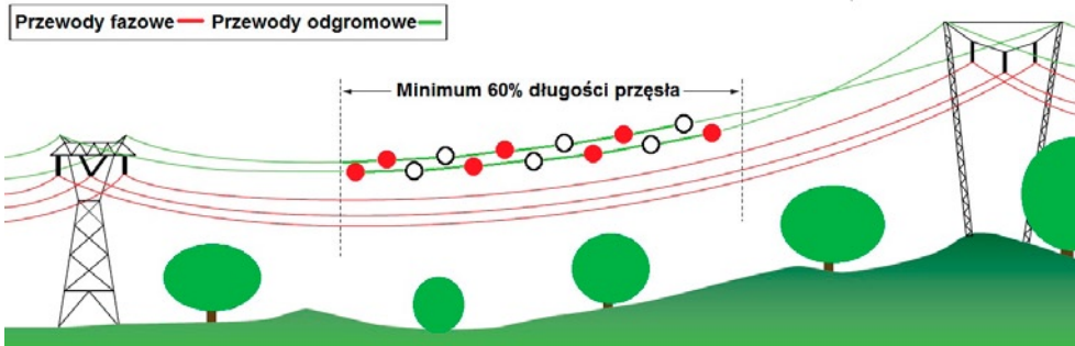
Ryc. 7. Sposób rozmieszczenia kul – widok z boku (na podstawie APLIC 2012). Fig. 7. Placement of sign spheres – side view (after APLIC 2012).
